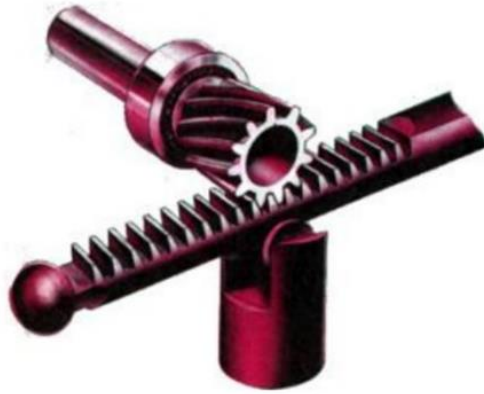
Detalle del piñón-cremallera de la dirección asistida
